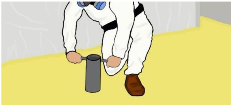
**Figure 4 : Prélèvement des éprouvettes par carottage**
